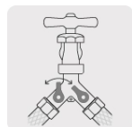
Válvulas de cierre de 1/4" de vuelta
